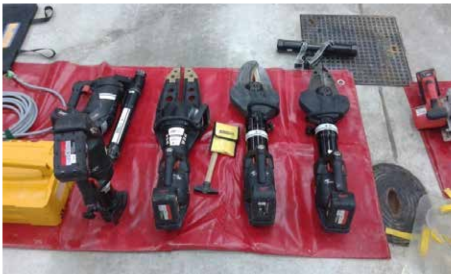
Slika 4. Elektrohidraulični alat (za rezanje i razupiranje) sa pogonom na baterije njemačkog proizvođača Weber
